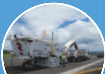
« Grâce aux systèmes de guidage 3D de Trimble pour le fraisage et le pavage, nous avons pu déposer 5 000 tonnes de bitume et effectuer le nivellement et la pente pendant la nuit, sur une période de 12 heures, comparé aux 2 000 ou 2 500 tonnes par période de travail en temps habituel. »
